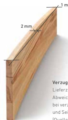
**Verzug:** Bereits im Lieferzustand darf eine Abweichung von 2 mm/1 m bei verzogenen Fronten und Seiten auftreten.
