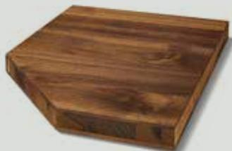
Die TEAM 7 3-Schicht-Technologie verbindet eine kompromisslose Ästhetik mit hervorragender Stabilität. Sie besteht aus drei Naturholzlagen, die kreuzweise aufeinander verleimt sind. Die Schichten sind jeweils um 90 Grad gedreht, was zu einer Absperrwirkung führt: Die einzelnen Schichten können nicht mehr ungehindert arbeiten. Dieser Effekt verleiht der TEAM 7 3-Schicht-Platte eine
