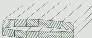
**Quellen:** Bei feuchter Luft nimmt trockenes Holz die Luftfeuchtigkeit auf. Es kommt zu einer Vergrößerung der Zellwände. Die Form des Holzes ändert sich, es wird größer.
