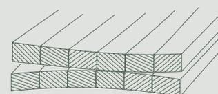
**Schwinden:** Bei trockener Luft geben feuchte Holzzellen Feuchtigkeit ab. Die Zellwände werden dünner. Diese Verkleinerung nennt man Schwinden.
